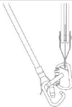
2. Raccorder le système d'extraction de secours à l'extrémité libre de l'élingue de canevas raccordée au système utilitaire de perche de sauvetage.
