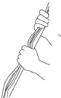
3. Tenez fermement le système d'extraction le long de l'arbre de la perche pendant l'utilisation de la perche de sauvetage pour faciliter la manipulation pendant l'opération.
