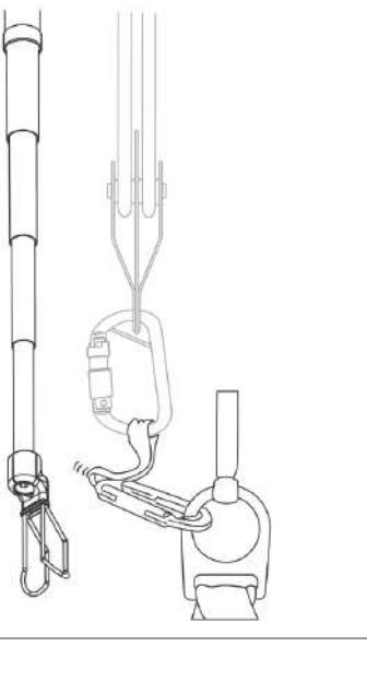
6. Confirmer visuellement la fermeture du dispositif de verrouillage du crochet distant.
